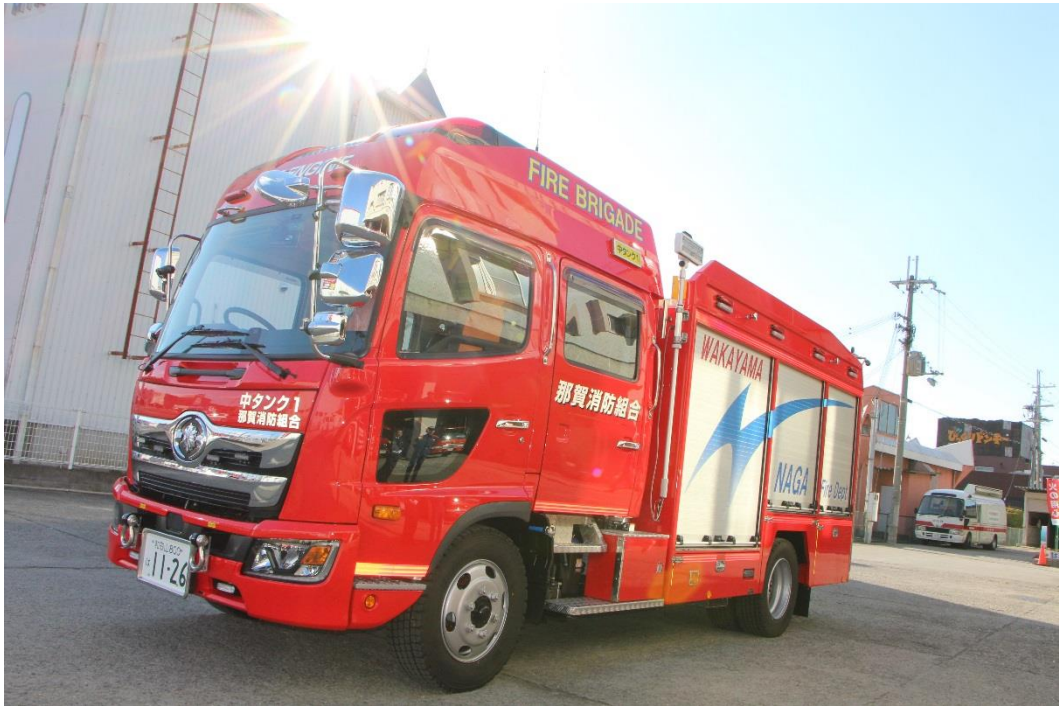
水槽付消防ポンプ自動車（H29.12 更新）
