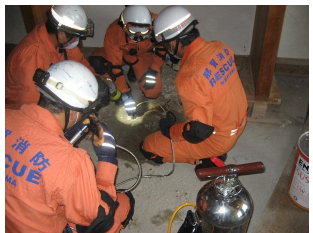
簡易画像探査機を使用しサーチングホール から床下の要救助者を検索
