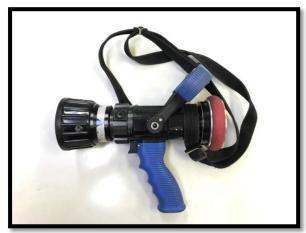
状況に応じ、放水量がダイヤルを回すことにより (OFF・1 1 0・2 3 0・3 6 0・4 7 0/Min)と 自由に切り替えができる他、放水パターン(棒状か ら噴霧)の調整が手元で簡単にできます。
